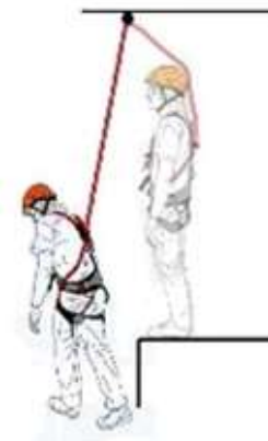
Altezza di caduta < 0,60 m
